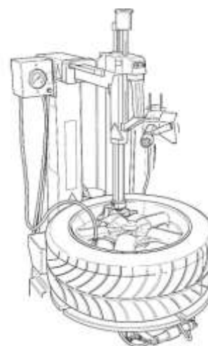
Fig. 4-4-1 Serrage de la roue avec l'outil
